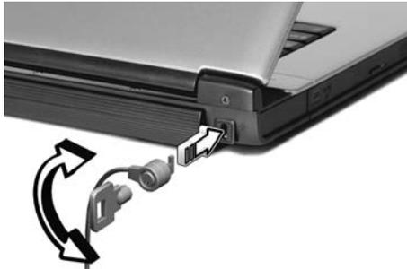
Enroulez le câble du cadenas de sécurité pour ordinateur autour d'une table, de la poignée d'un tiroir verrouillé, ou de tout autre objet fixe. Insérez le cadenas dans l'encoche et tournez la clé pour verrouiller le cadenas. Certains modèles ne possèdent pas d'encoche.
