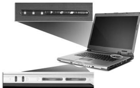
Les indicateurs d'état Alimentation, Batterie et Communication sans fil sont visibles même lorsque l'écran LCD est fermé.
